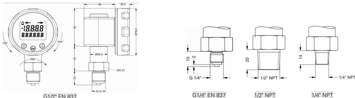
⇒ für Nenndruckbereiche P<sub>N</sub> > 60 bar erhöht sich die Länge der Geräte um 9 mm!
